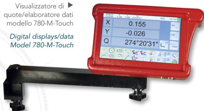
coordinate ed angolare, come pure l'elaborazione delle principali funzioni geometriche. Il dispositivo è completo di fibra ottica (sensore ottico) per la collimazione automatica sullo schermo (esclusivamente con la proiezione diascopica). Maggiori dettagli a pag. 36-37.
